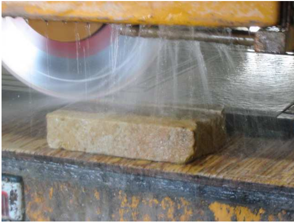
Obrázek 1: Oživení kotouče v abrazivním materiálu
